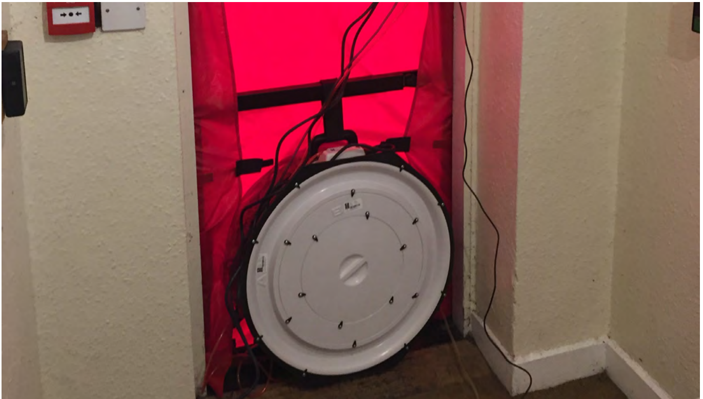
Left: Fan pressurisation test or 'blower door method'.
